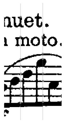
Otro dato fundamental que se determina en este procesado inicial de la imagen es la inclinación de la misma. Para hallar esta inclinación se buscan dos columnas a izquierda y a derecha de la imagen que contengan el número real de líneas encontrado. Comprobando las posiciones de los primeros inicios de las líneas del pentagrama en cada una de esas columnas, comenzando por el borde superior dela página, se obtiene la inclinación de la partitura.
